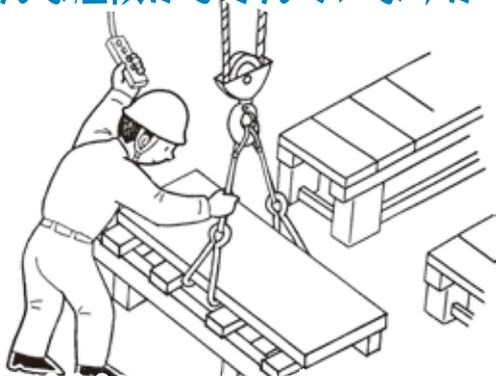
状況：あなたは、クレーンで鋼板(約1トン)をハッカー(吊り具)を用いて吊り上げ、パレット上に降ろしている。
